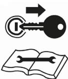
Desligue o motor e remova a chave do trator antes de realizar trabalho de manutenção ou reparo no equipamento.
